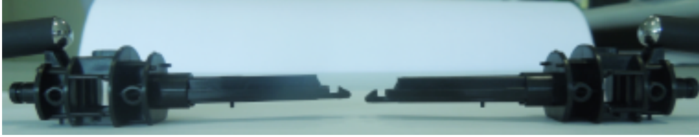
通过Moldflow优化的塑料件试模结果对比图，左边为优化前，右边为优化后
